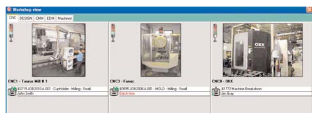
Atelier : cette fenêtre vous permet de voir instantanément et en temps réel quelles ressources sont occupées et lesquelles ne le sont pas.
